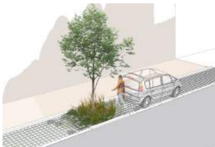
Principe du calpinage des pavés béton
